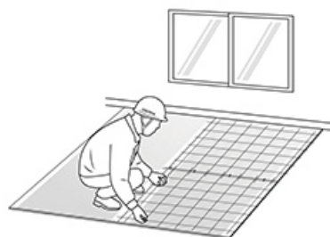
3 Установка проволочной сетки
