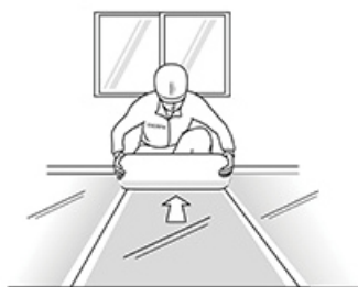
2 Установка фольгированного матраса
