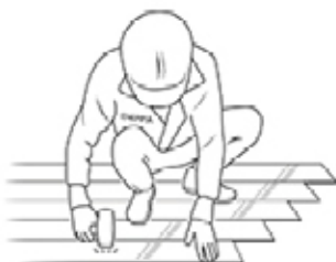
⑦ 마감재 설치
