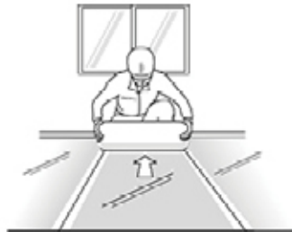
② 은박매트 설치
