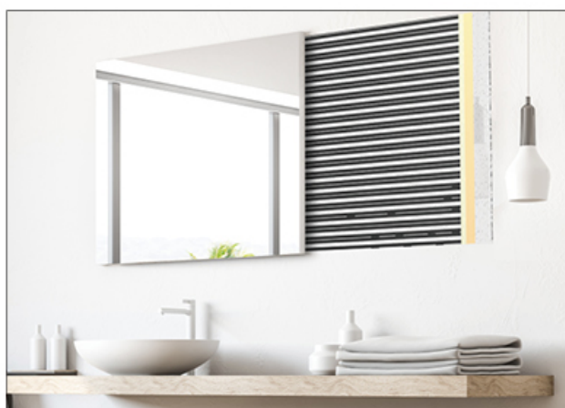
ミラー用暖房フィルムの施工構造図
