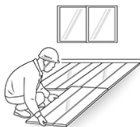
④ EPボードの直線部の設置
