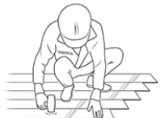
⑨ 仕上材の設置
