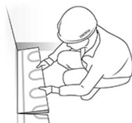
③ EPボードの曲線部の設置
